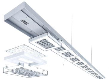
**Zumtobel, Sequence** | Ideato come apparecchio a plafoniera o sospensione, può essere composto da 8 o 14 moduli, ognuno dei quali contiene 6 x 3 punti luce LED disposti al centro. Con una sofisticata tecnologia di lenti, a emissione simmetrica o asimmetrica, i 18 LED centrali direzionano la luce in modo preciso mantenendola perfettamente schermata. Al contempo i 24 LED laterali coperti da una cornice opale generano una luminosità morbida e diffusa.
